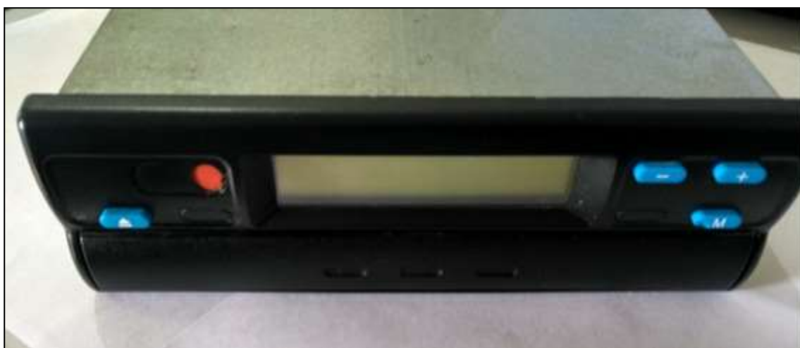
FOTO 2: Tacógrafo Modular VDO MTCO 1390
